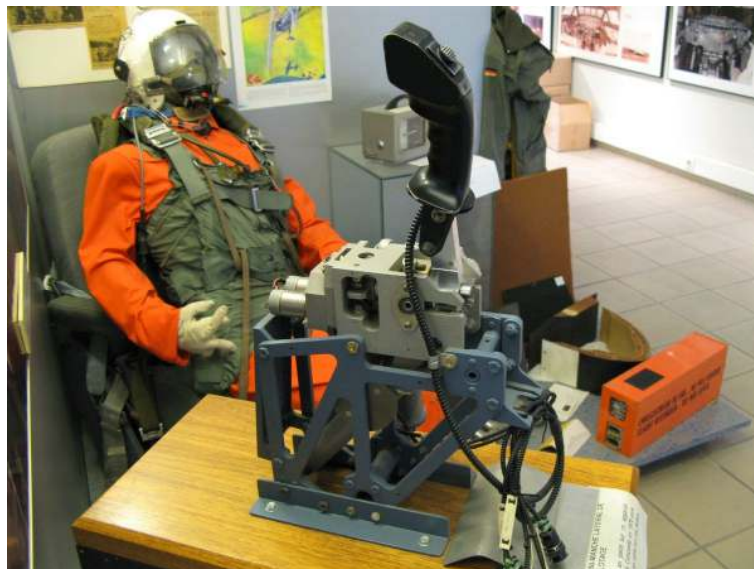
Le mini-manche monté sur Concorde préfigure le "side-stick" d'Airbus
