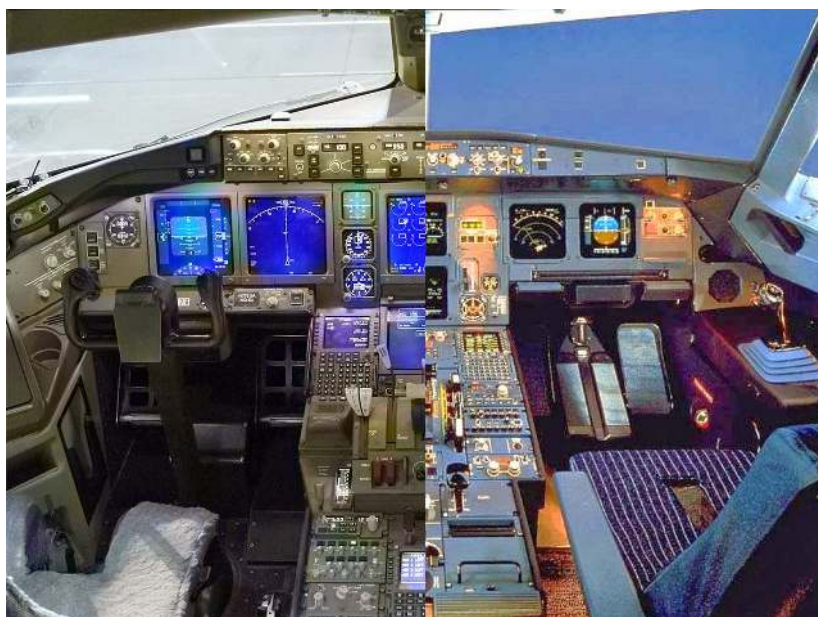
Similitudes et différences : à gauche le cockpit du Boeing 777 avec son manche classique, et à droite l'A330 et son mini-manche. Les deux constructeurs ont choisi des voies très différentes, mais les deux utilisent des CDVE.
