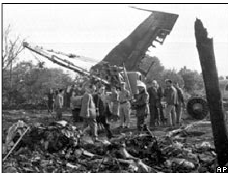
Les restes du "Chateau de Sully" après son crash, dû à un moteur électrique de trim bloqué ayant empêché l'appareil de décoller
