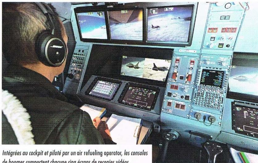
Intégrées au cockpit et piloté par un air refueling operator, les consoles de boomer comportent chacune cinq écrans de recopies vidéos.
